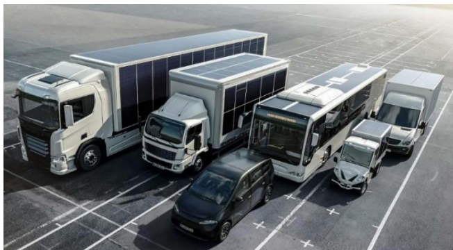
Figura 1.13. Tipuri de autovehicule cu panouri fotovoltaice integrate
