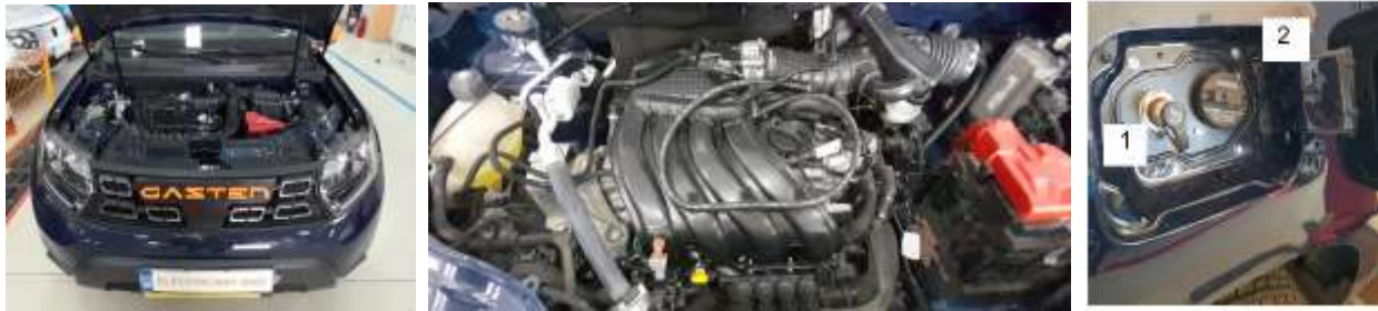
Fig 4.3 Noul grup motopropulsor termic al GASTER Electricway 4WD PHEV cu motor termic alimentat cu GNC cuplat cu o cutie de viteze automată, tip CVT
