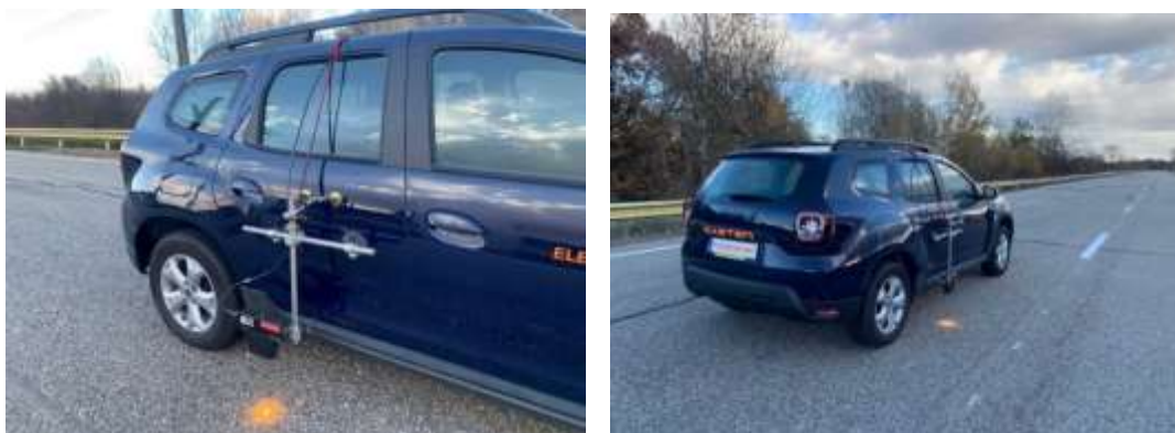
Fig. 7.6 Dispunerea echipamentului de măsurare și achiziții date Datron L400 cu senzor fără contact cu solul
