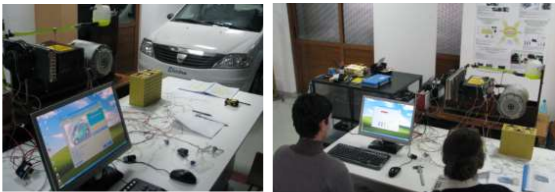
Fig.7.1 Aspecte de la testele de calibrare ale inverterului TIM 400 al motorului electric
