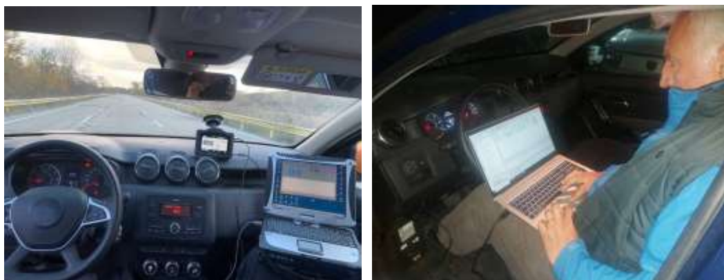
Fig. 7.12 Echipamentul de măsurare VBOX tip 3i RTK dispus în vehicul în timpul testelor din poligonul de încercări de la Merișani
