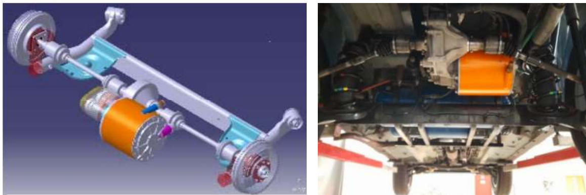
Figura 4.7 Puntea din spate de tip „H” (stânga) cu grupul motopropulsor electric-modelare CATIA (stânga) și implementarea lui pe conceptul GASTER Electricway 4WD PHEV (dreapta)
