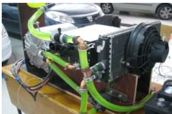
Fig. 6.9 Testarea pe standul de încercare și calibrare preliminară a circuitului de răcire al echipamentului MES DEA
