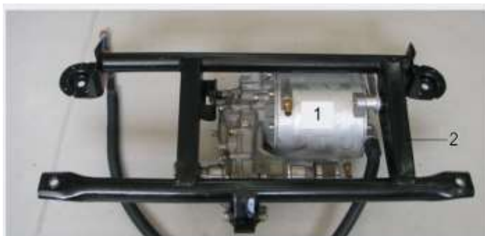
Fig.6.2 Grupul motor electric asincron și transmisia ce înglobează reductorul și diferențialul montate pe un cadru nou construit adaptat la vehiculul Duster 4X2
