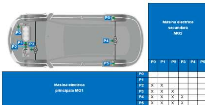
Fig. 2.25 Variante de arhitecturi hibride pentru tractiune integrala cu punte spate electrificata tip P4 sau P5
