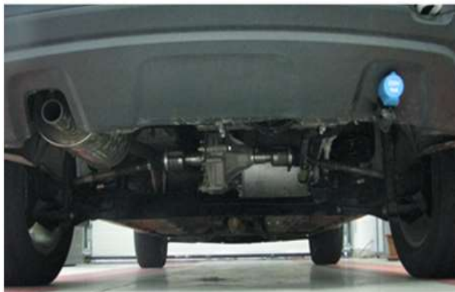
Fig. 2.28 Puntea din spate și grupul motopropulsor al conceptului „GRAND HAMSTER Electricway 4WD” [11] [12]
