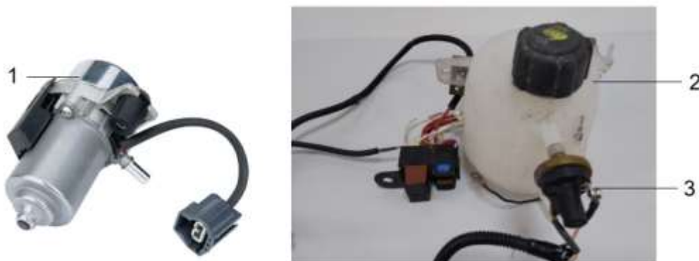
Figura 4.11 Componentele sistemului vacuumatic de asistare a sistemului de frânare construit pentru conceptul GASTER Electricway 4WD PHEV
