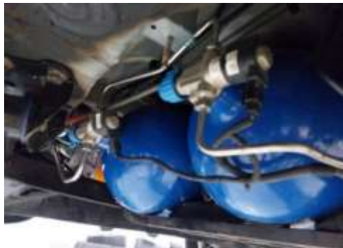
Fig. 5.12 Grupul multisupape ale rezervorului de GNC
